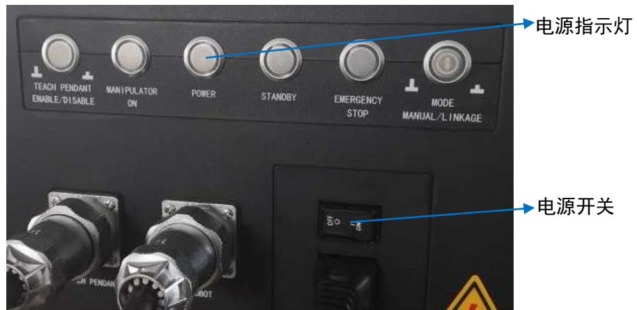
图 9-1 控制柜电源开关及指示灯示意图
