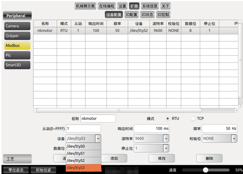
图 10-60 Modbus 设备配置
