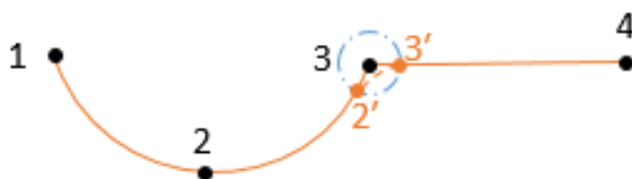
图 11-39 提前到达交融半径 Move arc-Move L 运行轨迹示例
