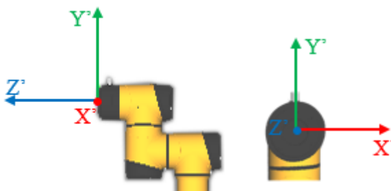
图 10-12 末端坐标系(flange_center)
