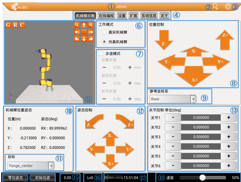
图 10-4 机器人示教面板示意图
