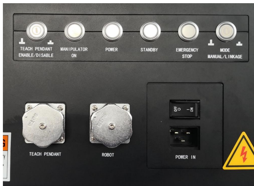
图 7-2 控制柜前面板示意图
